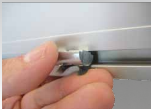
EINBAU EINER EINSCHWENKMUTTER M8
